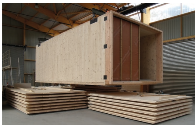
▲ Pour le déplacement des modules, l'entreprise a développé un système associant un palonnier et quatre équerres (pourvués de tétons) fixées sur le CLT.
